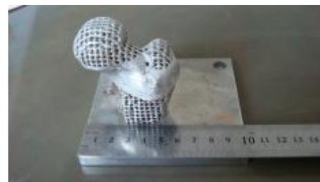
(增材制造设备打印的金属零件1)
