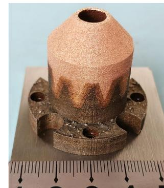
(增材制造设备打印的梯度材料零件)
